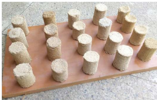
Sample B Orange peel: 80 % Corn cob: 20 %
