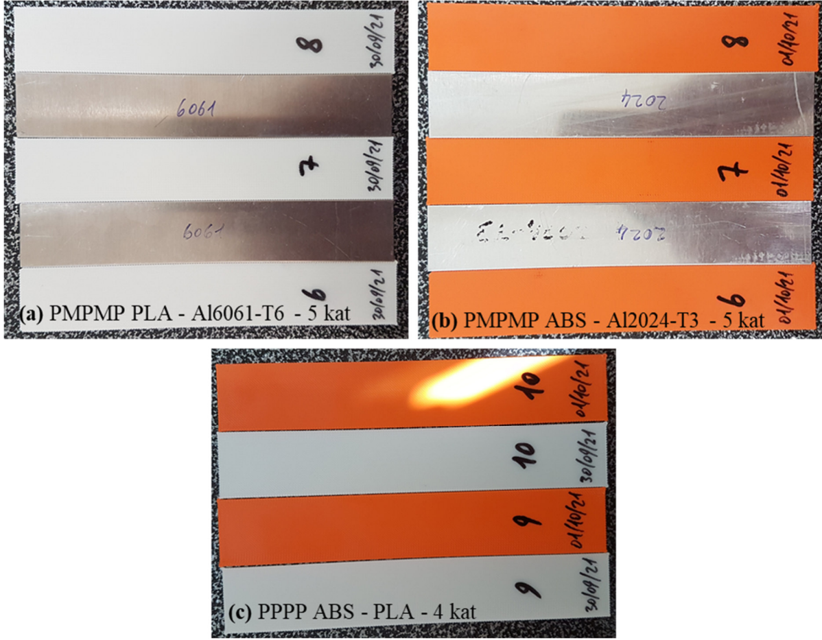
Şekil 1. Tabakalı kompozit üretiminde kullanılan levhalar (M – Metal, P – Polimer)
