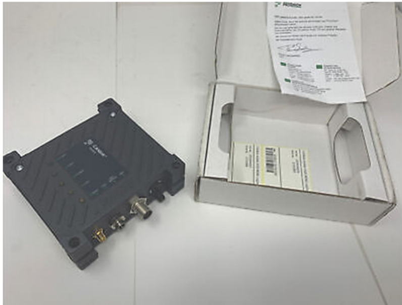
Şekil 2. Trambüs araçları üzerinde yer alan CanLogger 5102 kara kutu
