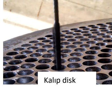
Şekil 8. Kalıp disk deliklerinin honlaması (Honing of die disc holes)
