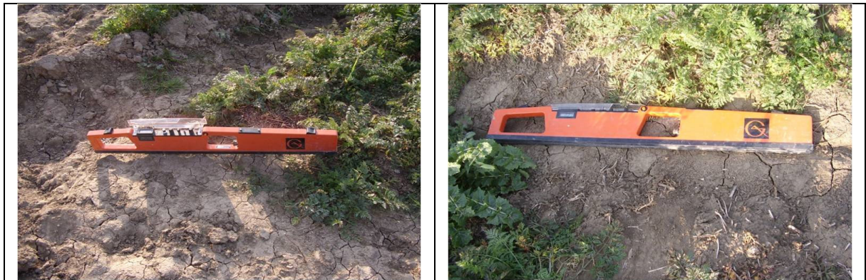
Şekil 2. EM38'in yatay ve düşey kullanımı sonucunda, sırasıyla toprağın 0-1 m ve 0-2 m katmanlarındaki tuzluluğun saptanmasına ait görüntüler.
