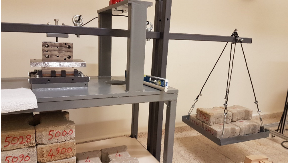
Şekil 3. Tabakalı kompozit üretiminde kullanılan mekanik pres
