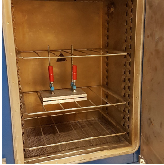
Şekil 3. Tabakalı kompozit üretiminde kullanılan fırın
