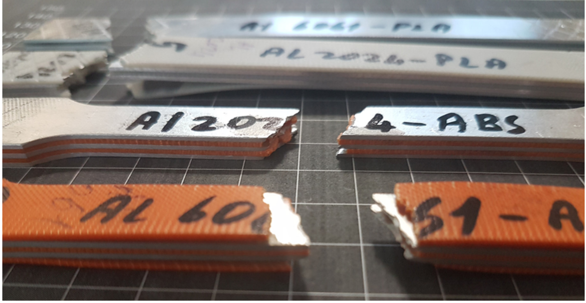
Şekil 9. Çekme testi sonrası kopmuş numunelerin yan görünüşleri
