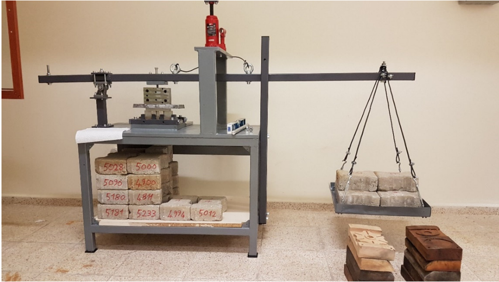
Şekil 2. Tabakalı kompozit üretiminde kullanılan mekanik pres
