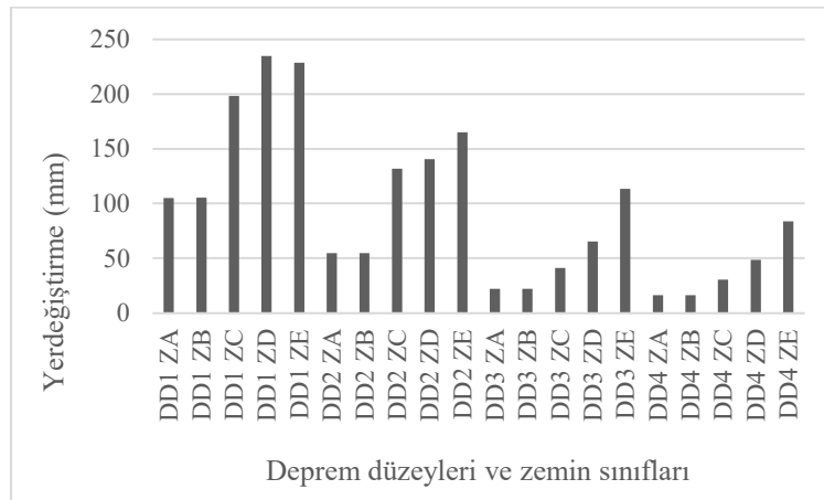
Şekil 9. İzmir ili tüm deprem düzeyleri ve zemin sınıfları için yer değıştirme değerleri
