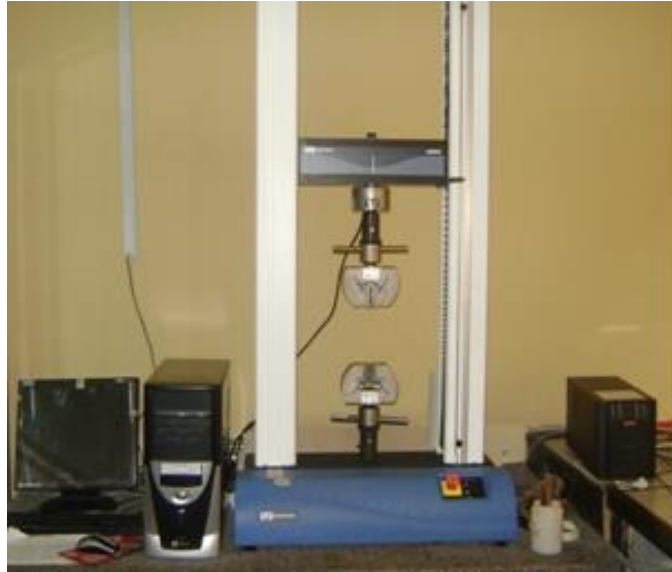
Plate VII: Universal instron machine (model 3369)
