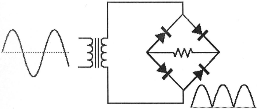
Fig. 3.4 Bridge rectifier
