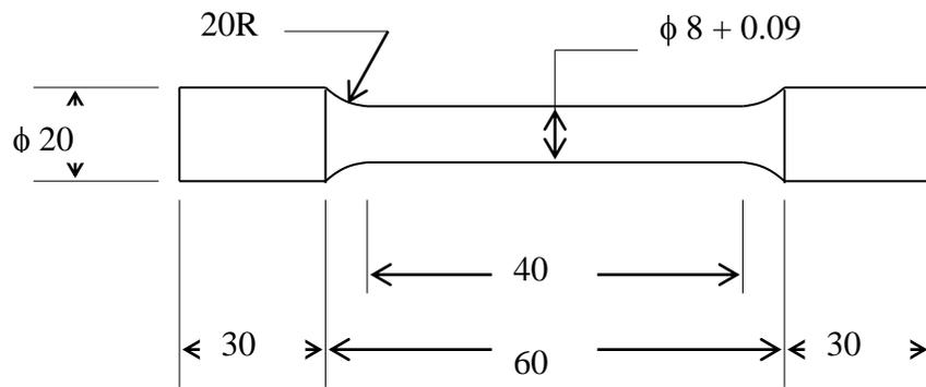
TENSILE TEST SPECIMEN
